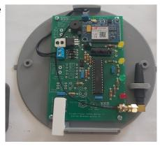
au démarrage en cas de coupure, il peut être changé à distance par le « Master » avec un commande SMS. Bien vérifier le branchement de l'antenne avant la mise sous tension du TPG-TONE.
