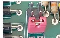
A utiliser lors de l'installation. Permet de voir si la détection de sonnerie a été ou pas détectée par le tempo-gache
